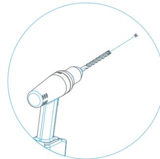
12mm Bohrdurchmesser, min 7cm tief
