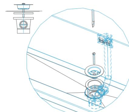
Überlauf mit M6x25 Zylinderkopfschraube (Inbusschraube) anschrauben.
