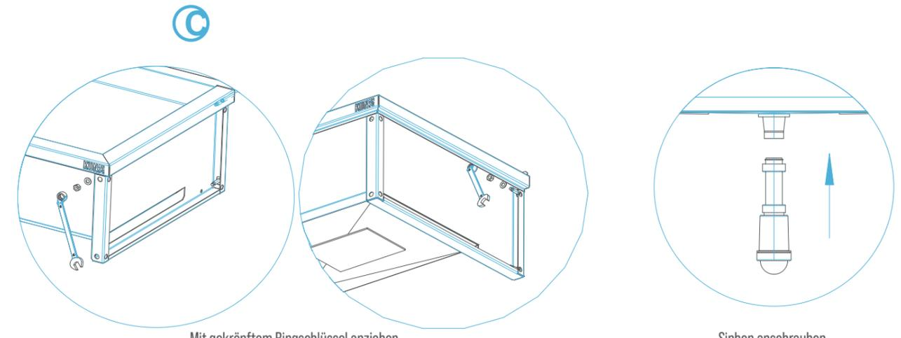
Mit gekrüpfem Ringschlüssel anziehen
