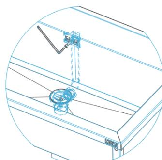
Überlauf mit M6x25 Zylinderkopfschraube (Inbusschraube) anschrauben.
