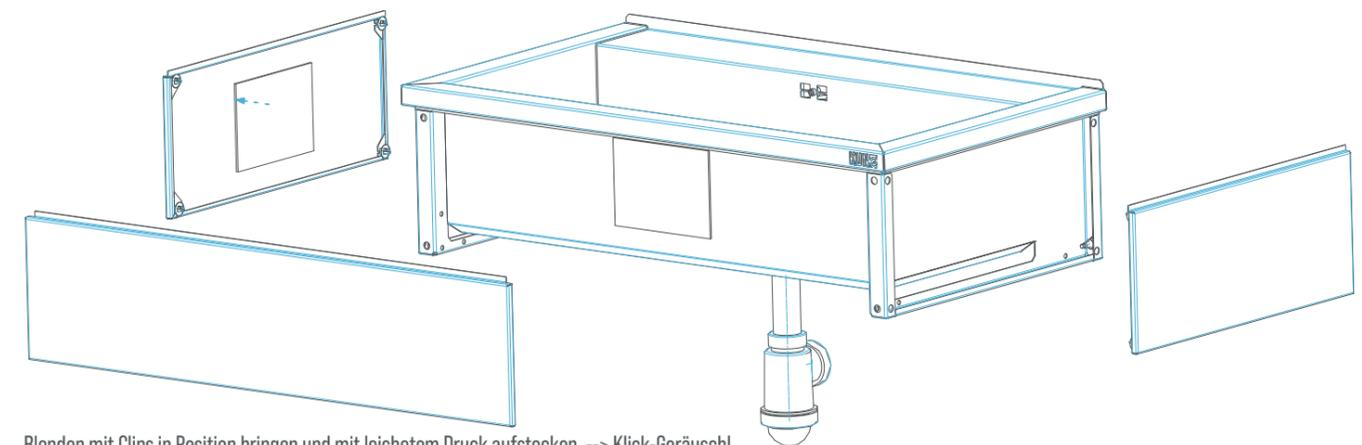
Blenden mit Clips in Position bringen und mit leichtem Druck aufstecken. --> Klick-Geräusch!
