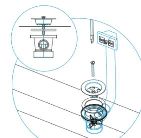
Ablaufsieb mit Ablaufventil verschrauben.
