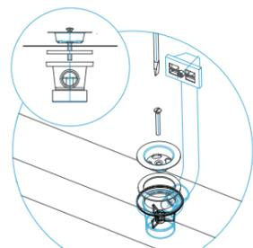
Ablaufsieb mit Ablaufventil verschrauben.
